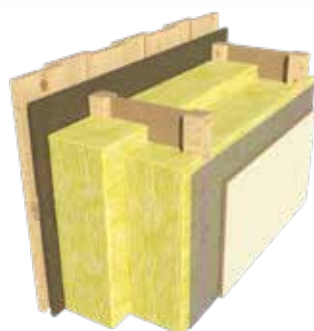
Masonite vegg med vindsperre av trefiberplate
