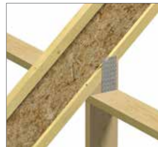
Med tilgang til spikerplate-presse kan kile festes til sperren med spikerplate.
