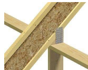
Med tilgang til spikerplatepresse kan kile festes til sperren med spikerplate.
