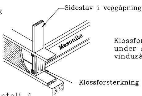
Klossforsterkning inntil gulvbjelke under sidestav i dør eller vindusåpning i bærende yttervegg.
